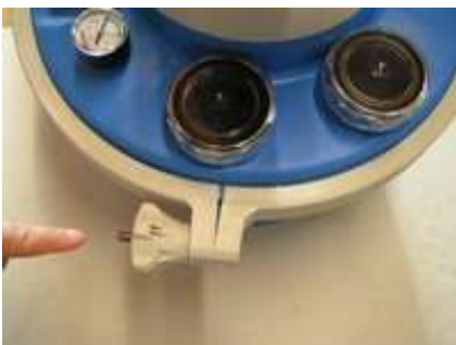
Kuvia 4.1a - huomaa muovinen kiristysnappi, jolla letkuliitin kiristetään
