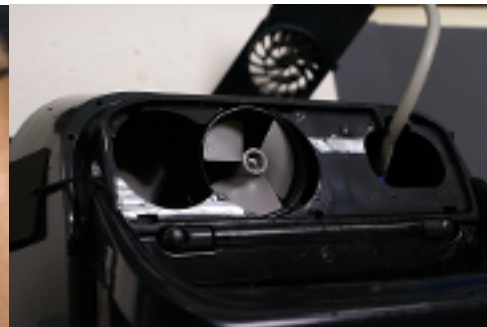
7.2 Puhdistakaa juoksuratas. 7.3 Asentakaa ritilä takaisin paikoilleen.
