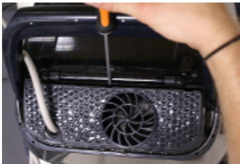
7.1. Käyttäkää tasapääruuvimeiseliä poistaessanne suojaavaa ritilää.
